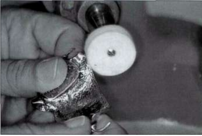
الشكل 11-11: يتم الصقل النهائي بعمجلة لبادية مع مادة ملمعة
